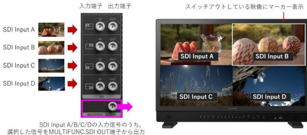
MULTI FUNC.SDI OUT 端子によるスイッチアウト (イメージ)
