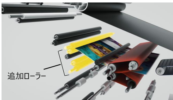
ローラー間の距離を近づけ用紙搬送力を強化
