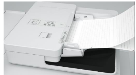
ADF でのチャートスキャンによる調整
