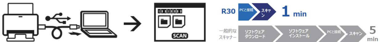
“imageFORMULA R30”はキヤノン電子の特許技術により、スキャナー本体にソフトウェアが内蔵されているため、一般的なスキャナーとは異なりドライバーやソフトウェアをパソコンにインストールする必要がありません。付属のUSBケーブルでパソコンと接続し画面に表示されるソフトウェアを選択するだけで、スキャナー本体に内蔵されているソフトウェア「CaptureOnTouch Lite」が起動し、利用を開始できます。利用時にドライバーやソフトウェアをWEBサイトからダウンロードしたり、OSのバージョンアップにより再インストールする手間を省きます。
