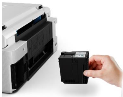
プリントヘッドやメンテナンスカートリッジをユーザー自身で簡単に交換可能
