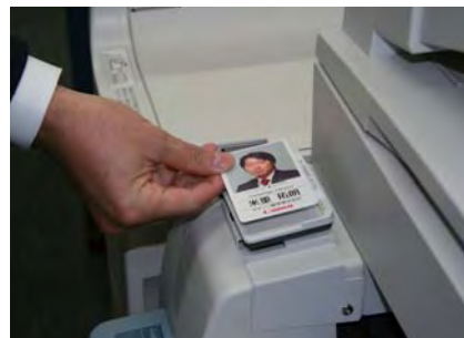
ICカード式IDカードを用いたセキュアプリント
