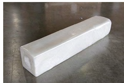
溶解固形化した発泡スチロール
